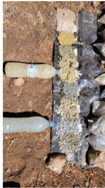
Les deux aquifères (au niveau des bouteilles) surmontés par un niveau argileux sombre
